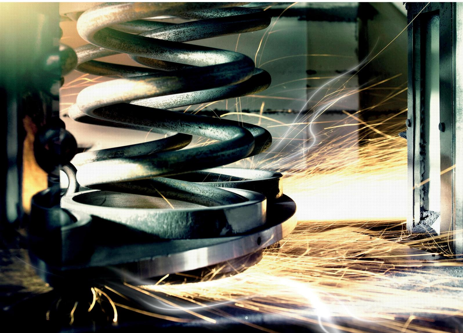
THELEICO stellt Produkte zum Schleifen aller auf dem Markt vorhandenen Federtypen und Werkstoffe her. Unsere Schleifscheiben und Schleifkörper eignen sich zum ein- oder doppel-seitigen Planschleifen von Federenden. Unsere Produkte sind wahlweise im Trocken- oder Nassschliff einsetzbar, abhängig vom Durchmesser der Feder und des Drahtdurchmessers.
