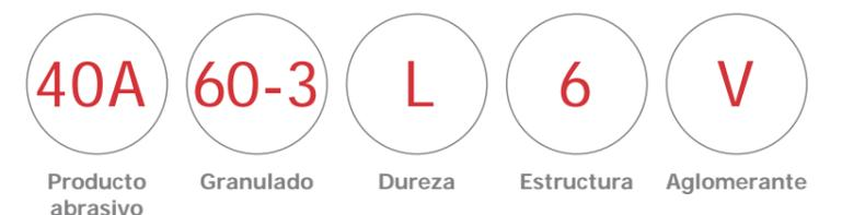
Ya que el rectificado suele realizarse en la fase final del proceso de producción, la calidad de una herramienta abrasiva influye considerablemente en los costes de fabricación. Las herramientas de
